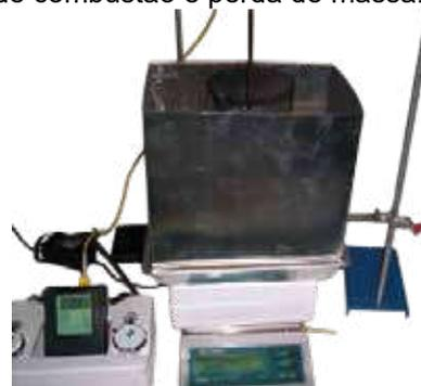
As folhas foram cortadas em dimensões menores que 10cm de largura por 15cm de altura para serem dispostas verticalmente no cesto, que foi então inserido no combustor. O combustor foi colocado sobre uma balança com sensibilidade de 10<sup>-2</sup>g. Um termopar foi posicionado a 10cm acima da borda do conjunto combustor balança, para ficar em contato com a chama. Um recipiente contendo 40 ml de Álcool 92,8° INPM (densidade 0,80g/
