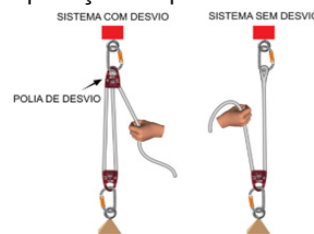
Figura 2 – Demonstração ergonomia com aplicação da polia de desvio
