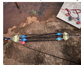
Figura 6 – Sistema 10:1 para elevação da carga
