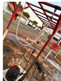
Figura 5 – Sistema 1:1 isolado para mensurar a perda de eficiência
