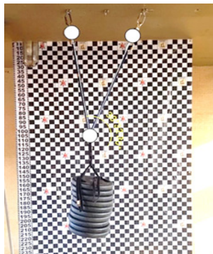
Figura 3 – Ancoragem equalizada com fita
