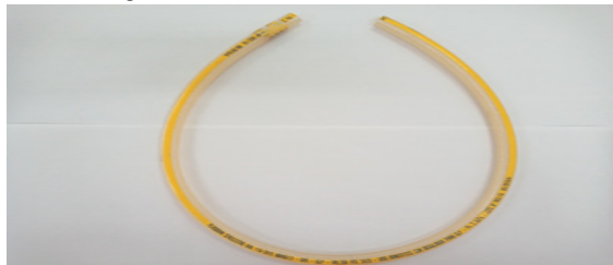
Figura 2 – Mangueira de PVC em conformidade com a NBR 8613.
