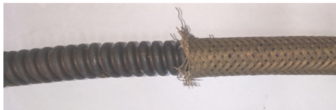
Figura 12 – Trinca em um tubo flexível metálico. A fotografia foi tirada em 20/04/2021.
