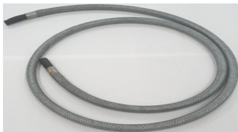
Figura 5 –Mangueira de borracha com malha trançada de metal. Neste caso, observa-se a falta de identificação e prazo de validade da mangueira.
