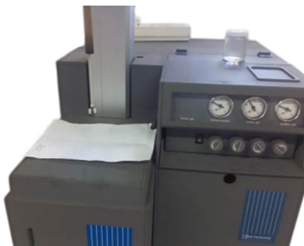
Figura 2. Termobalança SetSys 12 Setaram apresentando cadinho com biomassa.
