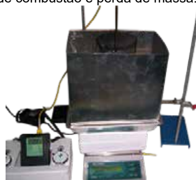
Figura 3. Aparato instrumental para experimento de combustão e perda de massa.
