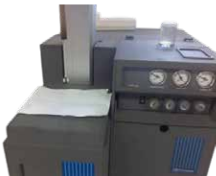
Figura 2. Termobalança SetSys 12 Setaram apresentando cadinho com biomassa.
