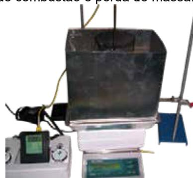
As folhas foram cortadas em dimensões menores que 10cm de largura por 15cm de altura para serem dispostas verticalmente no cesto, que foi então inserido no combustor. O combustor foi colocado sobre uma balança com sensibilidade de 10<sup>-2</sup>g. Um termopar foi posicionado a 10cm acima da borda do conjunto combustor balança, para ficar em contato com a chama. Um recipiente contendo 40 ml de Álcool 92,8° INPM (densidade
